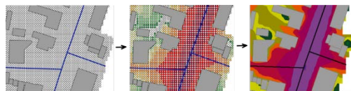
Figura 4 Fluxul de lucru în cartografierea zgomotului și rezultatele acestuia (grid cu puncte regulate - puncte având niveluri de dB(A) și simbologie atașate - harta strategică de zgomot)
